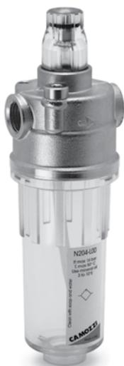
I lubrificatori della Serie N sono disponibili con attacchi da G1/8 e G1/4. Il particolare tipo di costruzione permette una vasta gamma di utilizzo in rapporto al numero di gocce d'olio nebulizzate e l'aria consumata. Il corpo del lubrificatore è in OT58 mentre la tazza è in tecnopolimero trasparente.
