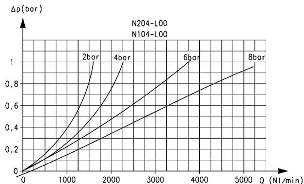
Diagramma di portata per modelli: N204-L00 e N104-L00
