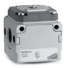
Le valvole ad avviamento progressivo sono utili per impedire danni a cose o persone quando si pressurizza un impianto pneumatico. Le caratteristiche di questi componenti permettono di pressurizzare un impianto gradatamente fino al 50% circa della pressione impostata, dopodichè il 100% lo si raggiunge in un tempo brevissimo. La collocazione naturale è ubicata a valle del FRL, infatti la flangiatura consente la perfetta adattabilità con tutta la Serie MC.
