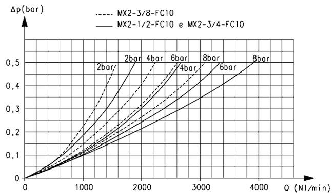
Diagramma di riferimento per tutti i modelli con elemento filtrante = 1 μm
