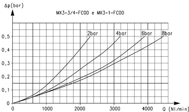
Diagramma di riferimento per tutti i modelli con elemento filtrante = 0,01 μm
