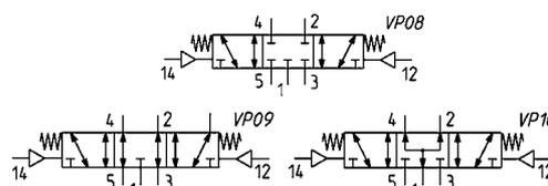
**Valvola a comando elettropneumatico monostabile - passo 10,5**
