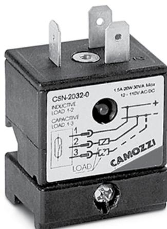
Il sensore è dotato di un particolare sistema di staffaggio che permette all'operatore di fissarlo direttamente sul tirante per mezzo di due viti che assicurano la posizione in senso longitudinale all'asse del cilindro e per mezzo di una terza vite che funge da posizionamento antirrotatorio. Le tre uscite sono contraddistinte dai numeri 1, 2 e 3 (vedi schema).
