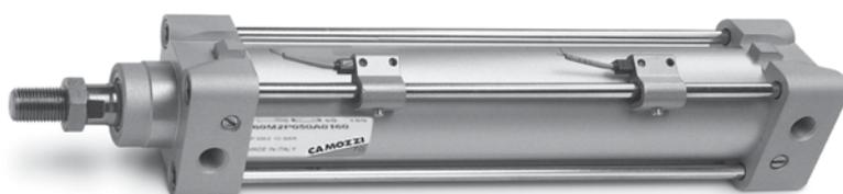
I cilindri Serie 60 sono stati realizzati rispettando gli ingombri delle norme ISO 15552. Sul pistone dei cilindri è alloggiato un magnete permanente che rende possibile, attraverso i sensori disposti lungo l'asse di scorrimento dello stelo, l'emissione di segnali elettrici che ne indicano la posizione.
